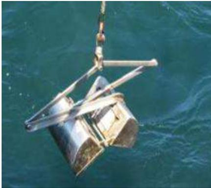
1. Se activa el sistema de bloqueo de la draga en su posición de “bocas abiertas” y se introduce lentamente hacia el fondo marina, sistema de bloqueo se desactiva en cuanto la draga toca el sedimento, de forma que las bocas se cierran instantáneamente encerrando el sedimento dentro de la cavidad.
